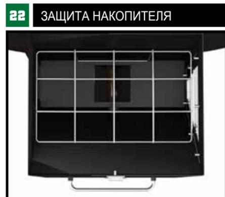
Открываем крышку накопителя и устанавливаем защиту.
