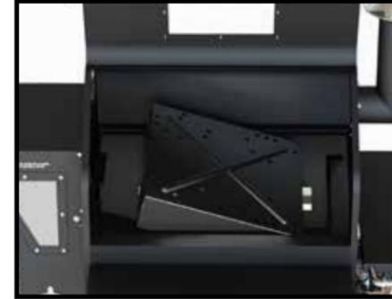
Устанавливаем отсекаТЕЛЬ жара на полозья из нержавеющей стали на передней и задней стенке.
