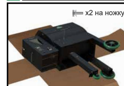
Устанавливаем ножки с роликами слева, под накопителем, ножки с большими колесами - справа.
