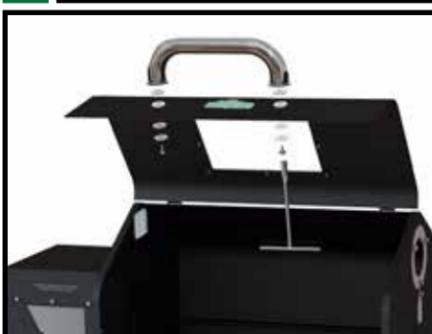
Используя снятый с нее же крепеж, прикручиваем ручку снаружи крышки.
